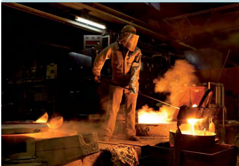
Abschrecken einer Edelstahlschmelze bei einer Temperatur von 1.600 Grad Celsius
