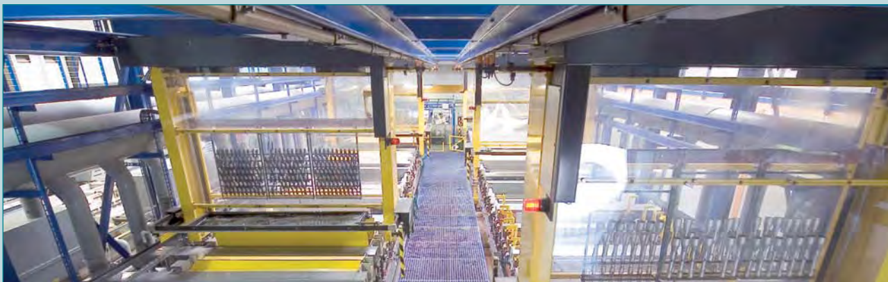
Eloxal-Vollautomat zur Beschichtung hochwertiger Aluminium-Teile mit passgenauen dekorativen Oberflächen
